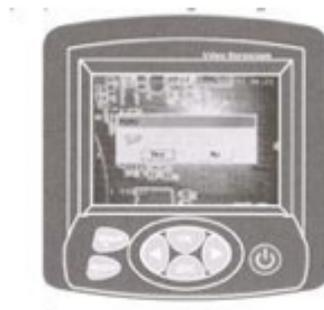
Mueva el cursor de derecha a izquierda para seleccionar YES y presione el botón de "OK" para entrar en los ajustes del sistema, como se muestra:
