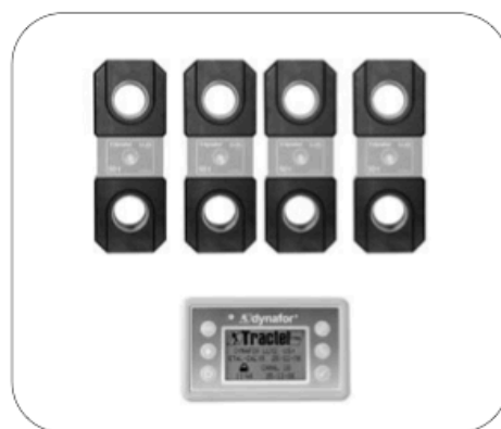
4 sensores asociados a un caja de visualización
