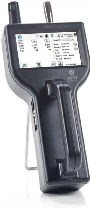
Los contadores portátiles de partículas Airy Technology® H303 y H503 miden 0.3 o 0.5 a 25.0  $\mu\text{m}$  con un caudal de 0.1 CFM (2.83 LPM). Fáciles de configurar, estos instrumentos muestran hasta 3 canales de tamaño seleccionable por el usuario, así como la temperatura y la humedad relativa. Ver datos o exportar a software de gestión de instrumentos (IMS). Los contadores Airy Technology® se pueden controlar y monitorear de forma remota a través del navegador web.
