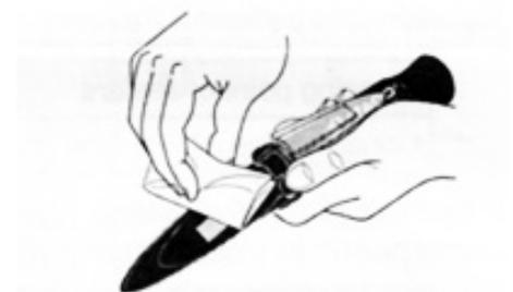
✘ Después de cada medición, limpie la muestra del prisma, la placa de la luz del día y alrededor del área del prisma con un pañuelo suave y húmedo
