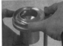
6. Retire el dedo del orificio de la copa y espere unos cuantos minutos para permitir que cualquier burbuja de aire suba hasta la parte superior del líquido.
