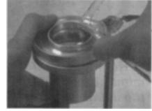
5. Deslice la placa de vidrio sobre el borde de la copa para retirar el exceso de muestra. Evite la formación de burbujas de aire entre la placa de vidrio y el líquido.
