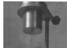
La viscosidad cinemática medida se expresa generalmente en segundos (s) tiempo de flujo, que se puede convertir en Centistokes (cSt). Para convertir, utilizar el disco de viscosidad Biuged 2400– ver “Equipo relacionado”
