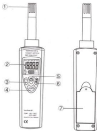
1) Sonda de humedad y temperatura de aire: Los sensores semiconductores de humedad y temperatura están dentro.
