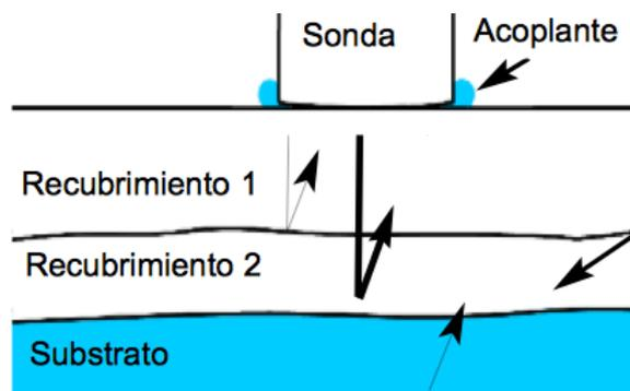
El **Positector 200** interpreta el “eco” mayor dentro del rango seleccionado como eco del recubrimiento/recubrimiento o eco de recubrimiento/sustrato.
