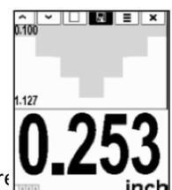
Una pantalla que muestra el corte transversal del material medido.
