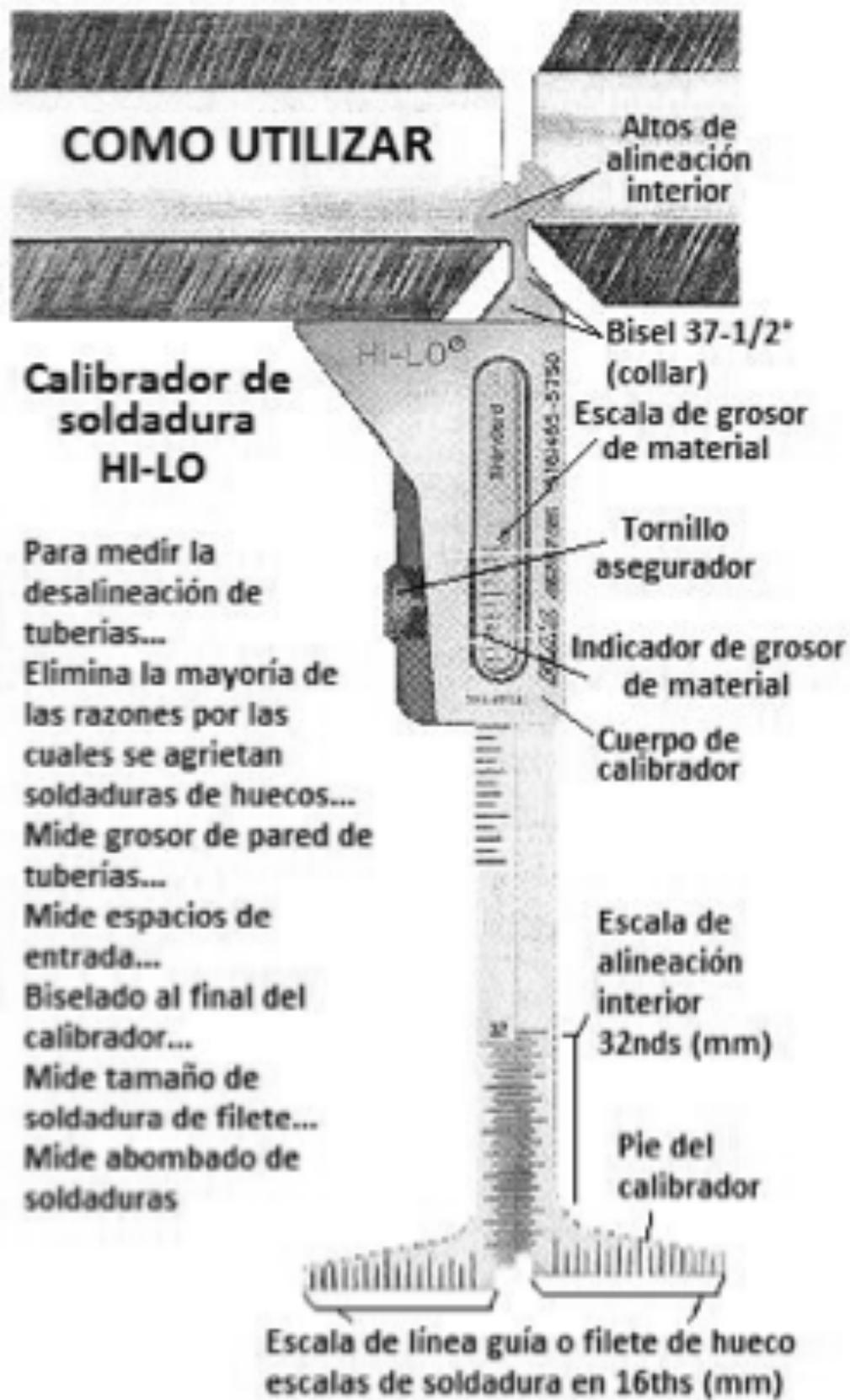
Inserte la punta del calibrador a través del hueco
