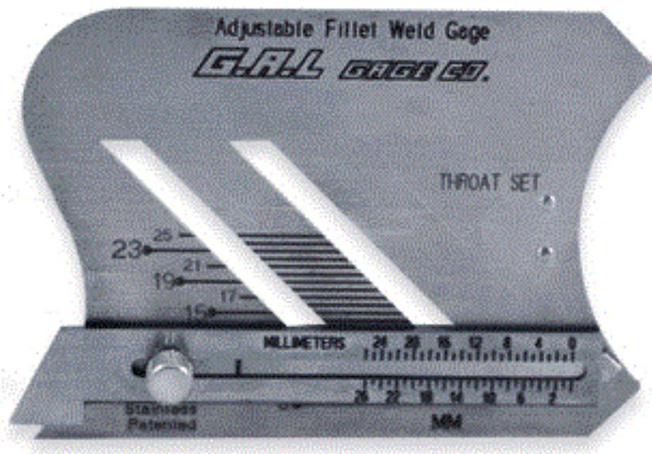
**Medidor de Filete de Soldadura**
