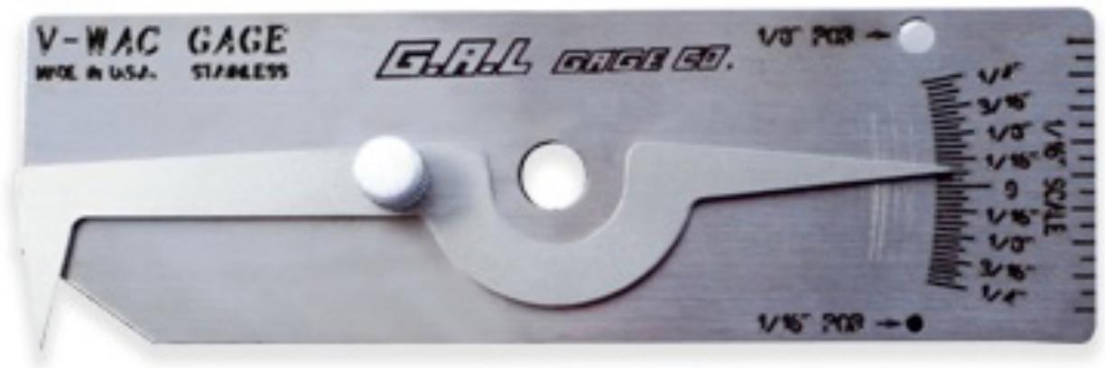
**Calibradores de Soldadura**
