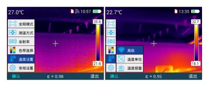
再按"确认"键或者"▶"键进入"高级"菜单,在"高级"菜单下可以对反射温度、相对湿度、和测温距离进行数值的调节。如下图所示。
