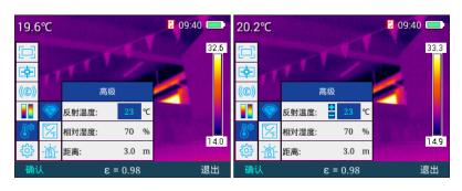
在"高级"菜单模式下按"+"、"-"选择对应的选项进行调节,按"▶"键,出现加减号,进入"反射温度"调节菜单,此菜单下再按"+"、"-"可以进行数值调节,按"确认"键保存调节后的数值,按"◀"键退到上一级菜单。相对湿度和距离跟环境温度菜单的操作方式相同,不再赘述。按"退出"键返回到主菜单模式下。
