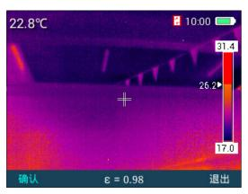
"下等温线"通过"+""-"键选择低温色带,显示为蓝色,实时图像中同时显示对应低温度区域,如下图所示。
