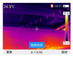
在融合模式下,可以调整红外与可见光的融合位置,按"确认"键,进入融合图像调整模式,按四个方向键键可以位移可见光图像,使可见光图像与红外图像重合,按"确认"键可以保存位移调整设置。
