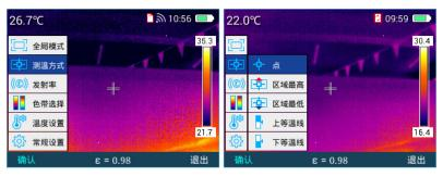
"点"分析模式下测试中心点的温度,如下图所示。
