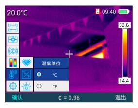
在"报警温度"菜单中按"▶"键进入高温报警、低温报警菜单,此菜单中按"+""-"号选择高温报警或者低温报警,此时选择的区域会蓝色高亮,再按"▶"键出现加减号,按"+"或者"-"键对报警温度值进行温度数值调节,高温报警温度时在区域分析中对于大于此设置的温度值蓝黑色十字光标会不停闪烁进行光标报警,低温报警温度时在区域分析中对于小于此设置温度值蓝黑色十字光标不停闪烁进行光标报警。按"确认"键保存当前设置的值,按"◀"键退回上一级菜单。按"退出"键退出此菜单回到主菜单目录。如下图所示。
