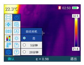
选择"否"表示不自动关机,选择"5分钟"表示5分钟后弹出自动 关机提示,若取消则保持开机状态,若无动作则自动光机;同理选择"20 分钟"表示20分钟后自动关机。
