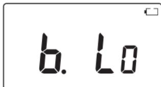
Cuando la carga es cero, **b. Lo** parpadea en la pantalla durante 3 segundos y la alimentación se apaga automáticamente.
