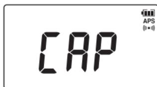
si presionas **0ADJ** entonces que la tapa del sensor suministrada no está conectada al sensor de iluminancia (cuando el conteo es equivalente a 1Xo más), **[GORRA]** aparece en la pantalla LCD. Presiona de nuevo **0ADJ** después después de colocar la tapa del sensor.
