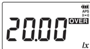
El valor máximo visualizable parpadea y **OVER** se ilumina en la pantalla LCD.
