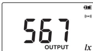
El voltaje se emite desde el terminal D/A SALIDA en función del valor medido. (**OUTPUT** se enciende.)
