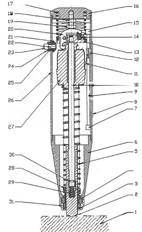
Figura 1 estructura de martillo de prueba HT225
