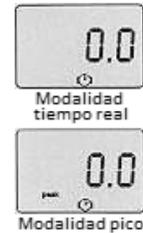
"Or PEAK" es la modalidad predeterminada de fábrica que mide pico de torque CW o pico de torque CCW. "And PEAK" mide ambos, pico de torque CW y CCW durante una prueba. Refiérase a la función F2 de la modalidad de programación tras encendido para la función "And PEAK".
